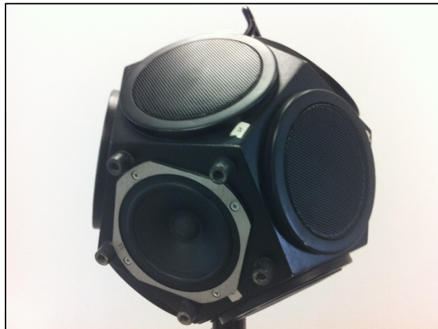
Figura1.-Fuente dodecaédrica Omnipower 4296 (Brüel &Kjaer)
