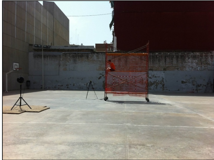
Figura6.- Montaje ensayo cobertura de fachada en planta baja con fte omnidireccional Omnipower 4296 (Brüel &Kjaer)
