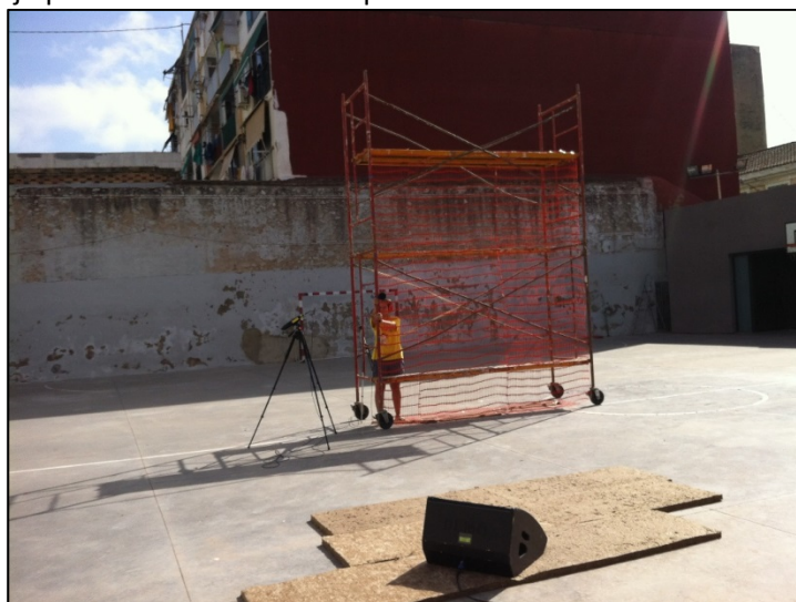
Figura5.- Montaje ensayo cobertura de fachada en planta baja con fte directiva unidireccional Beyma.
