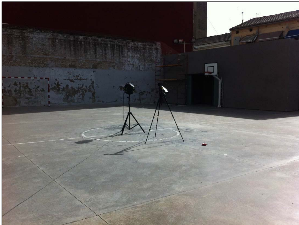
Figura5.- Medición de la directividad de la fuente sonora dodecaédrica Omnipower 4296 en condiciones de campo libre, según la norma UNE-EN ISO 140-4, anexo A.
