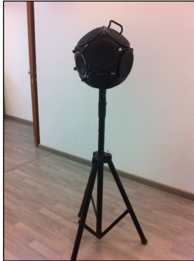
Figura2.-Uso convencional fuente dodecaédrica Omnipower 4296 (Brüel &Kjaer) sobre trípode h=1.5m.
