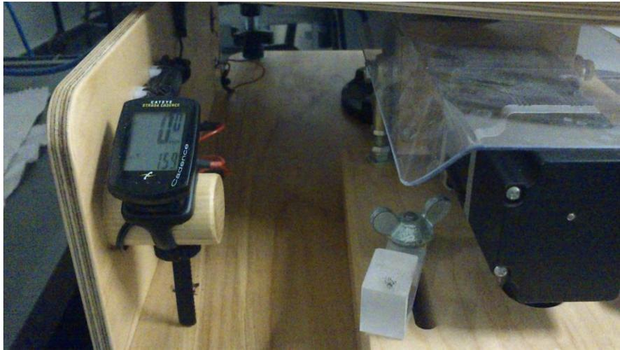
Fig. 11. Imagen del tacómetro instalado en la tabla giratoria.
