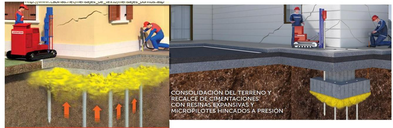
Recalce cimentaciones con inyecciones de resina expansiva y micropilotes hincados a presión
