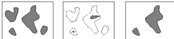
FIGURE 3.3 – (a) Particules. (b) Marquage de particules. (c) Particules reconstruites [51].
