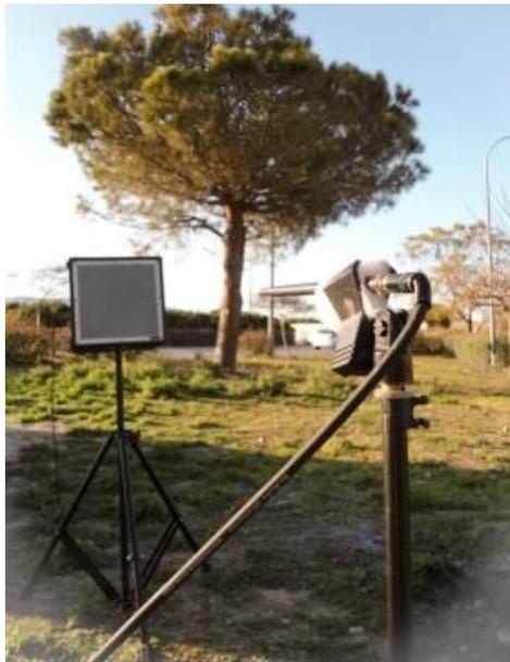
Figura 33: montaje para la obtención de la medida de sonido directo.
