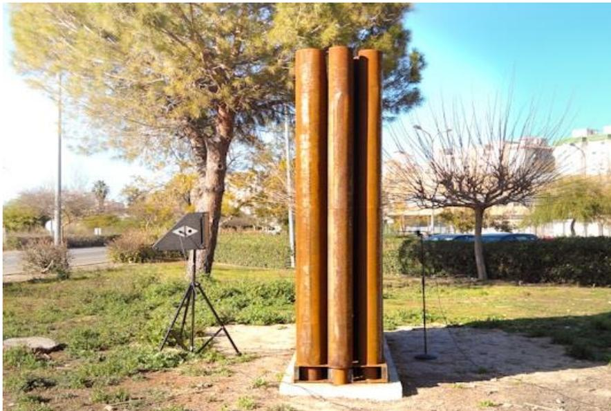
Figura 25: Montaje real de la medida experimental del aislamiento de la barrera acústica.
