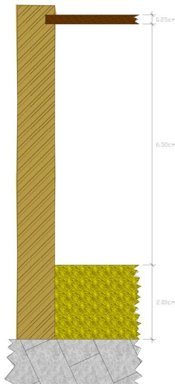
Figura 5.4.2j – Medidas de la sección de la membrana.
