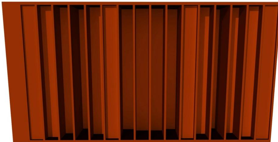
Figura 5.4.4b – Diseño del difusor con  $f_0 = 5000$  Hz.
