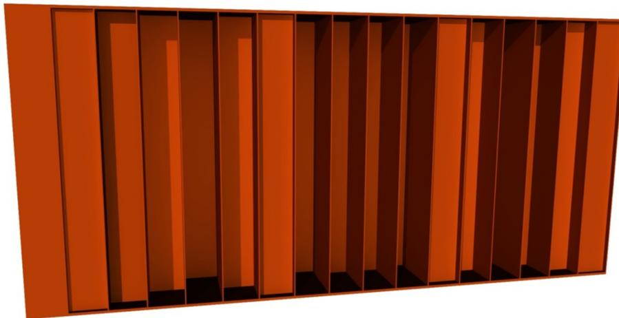
Figura 5.4.4a – Dise\u00f1o del difusor con f<sub>0</sub> = 1250 Hz.
