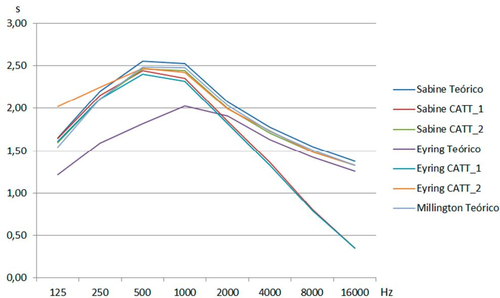
Figura 5.1e – Gráfica comparativa de los métodos de cálculo para del  $t_r$  en la sala de control (CR).
