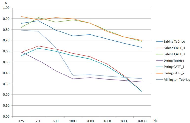
Figura 5.4b – Gráfica comparativa de los métodos de cálculo para del  $t_r$  en la sala de control (CR).
