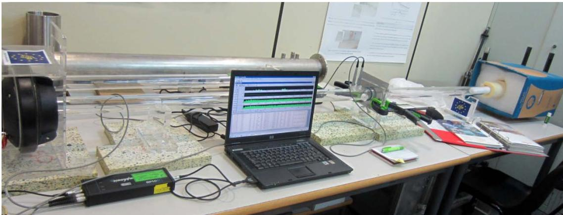
*Imagen VII. Montaje realizado para las medidas de pérdidas por transmisión.*
