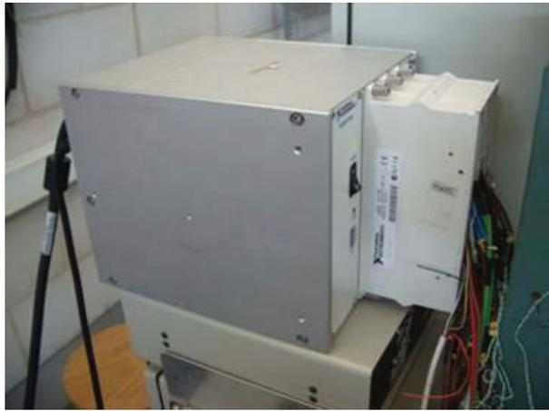
Fig. 4.34 Sistema de adquisición de datos
