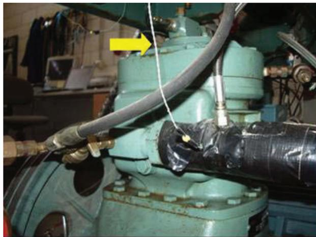
Fig. 4.28 Sonda de temperatura en la aspiración del compresor.
