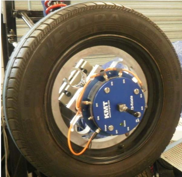
Fig. 24 Equipo de telemetría CT8-Wheel instalado en la llanta.
