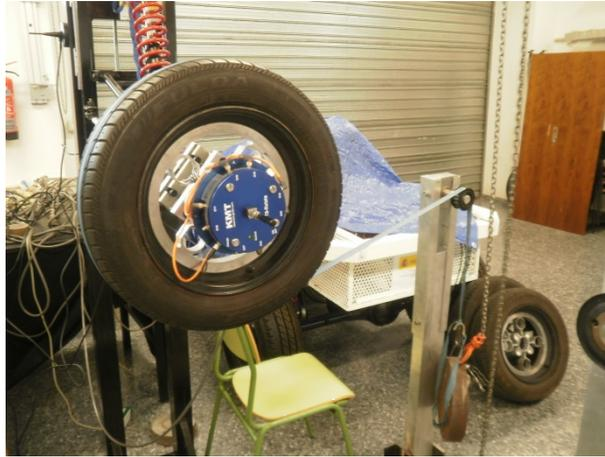
Fig. 25 Aplicación de una fuerza en la dirección X y aplicando  $M_y$
