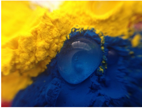
Figura 19: Demostración de impermeabilidad en el toner
