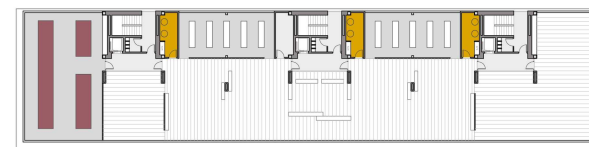
■ Batería de captadores solares ■ Cuartos para ubicación de los acumuladores
