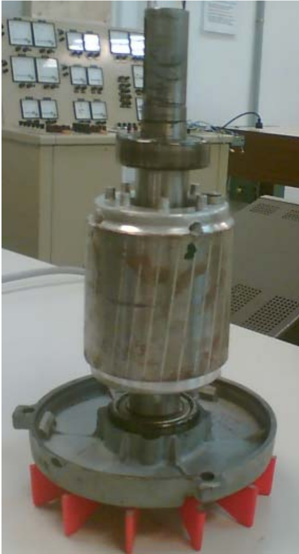
Figura A-12. Rotor con una barra rota.
