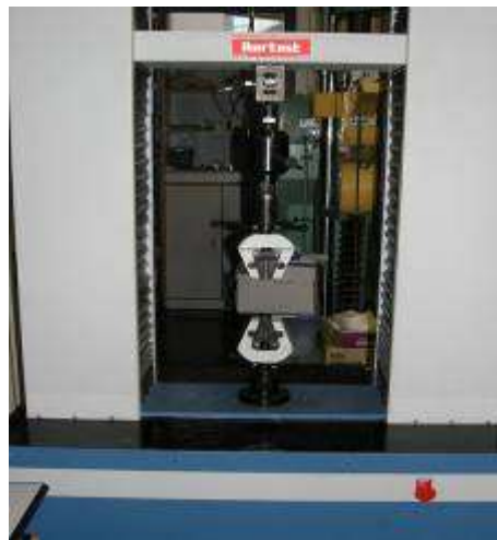
Fig. 4 Mașina de încercat la tracțiune folosită la experimentări
