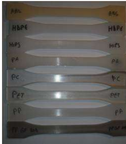
Fig. 3 Epruvete pentru încercări la tracțiune, executate prin injecție
