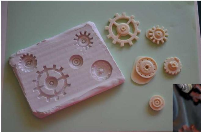
Figura 102. Molde de silicona y positivos en resina.
