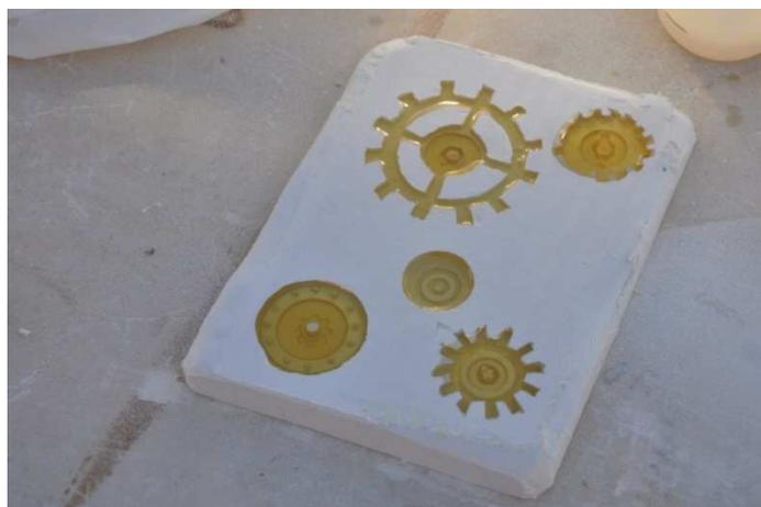
Figura 101. Molde de silicona RTV y resina aplicada para el positivado.
