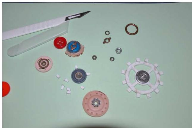
Figura 100. Prototipos de engranajes para sacar molde.
