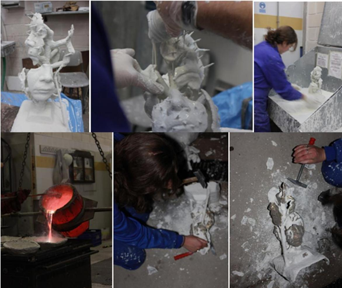
Proceso de realización de máscaras de latón, en los talleres de fundición en la UPV, 2013.
