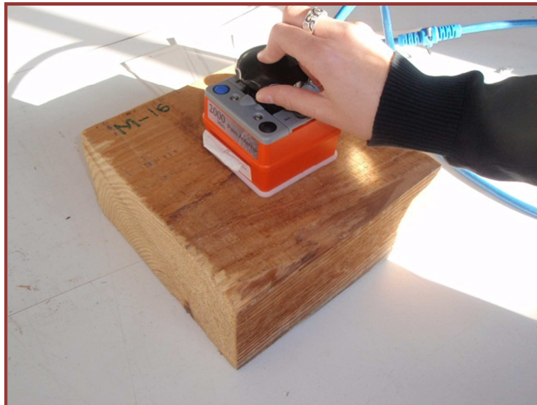
Figura 3.11. Ensayo estático con georradar..
