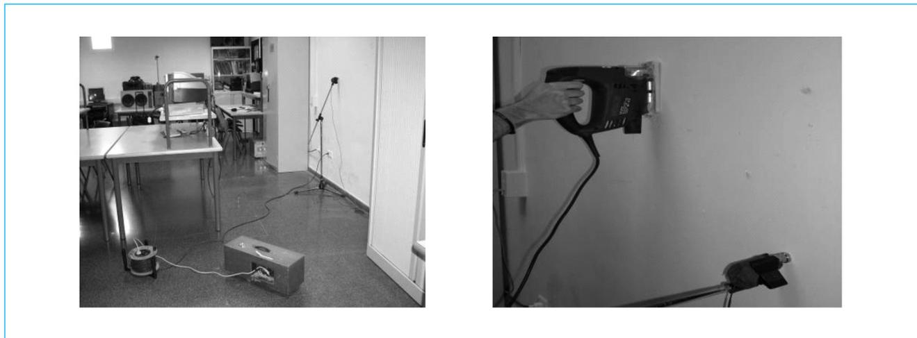
**Figura 3.** Medida del tiempo de reverberación estructural en una maqueta a escala de hormigón
