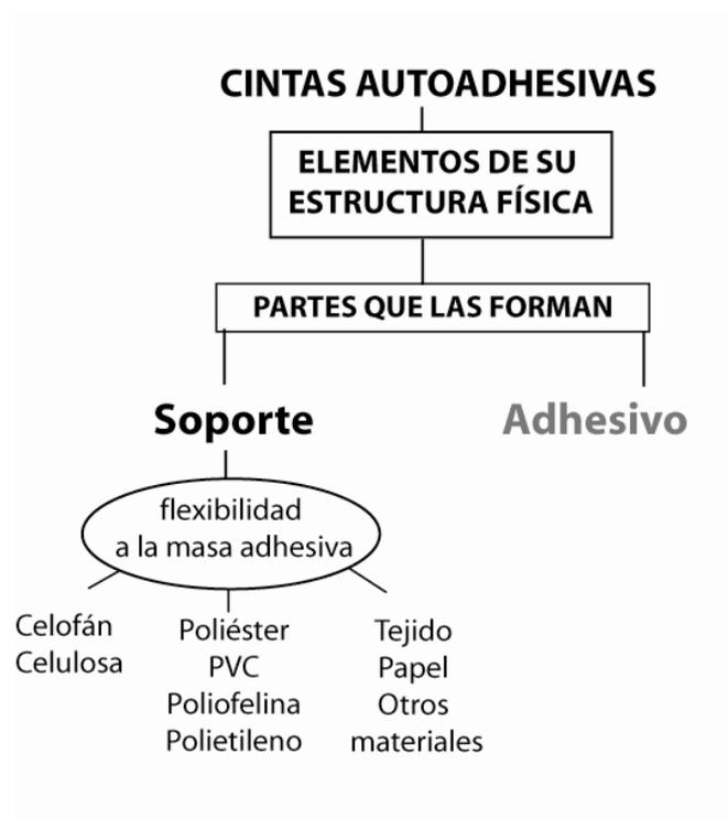
Fig.13. Esquema de su estructura física
