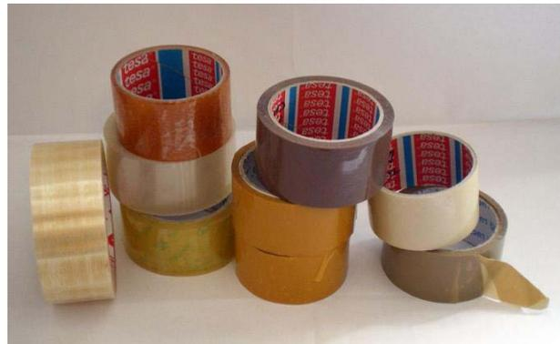
Fig.15. Cintas con soportes de PVC, Poliolefina transparente, etc.
