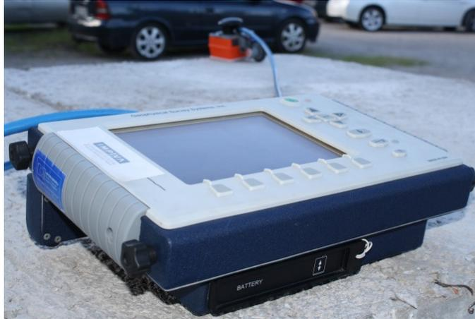
Fig. 2. Unidad de control y adquisición de lo equipo de georradar SIR-3000 de la marca GSSI
