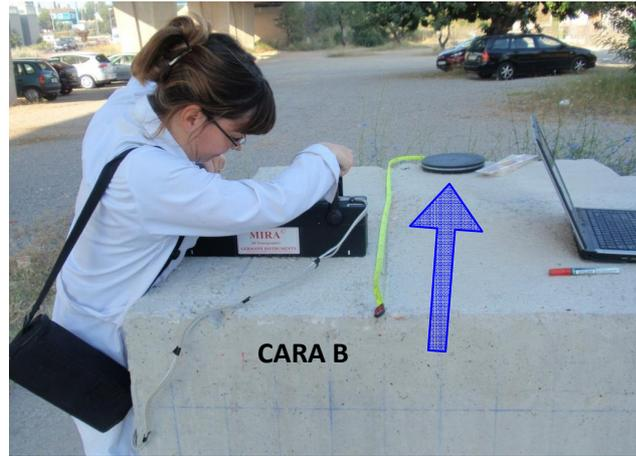
Fig. 61. Realización de medidas con tomógrafo ultrasónico MIRA
