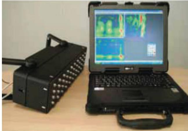
**Fig. 12.** Equipo de tomografía ultrasónica MIRA, de la marca Germann Instruments A/S, propiedad de AIDICO
