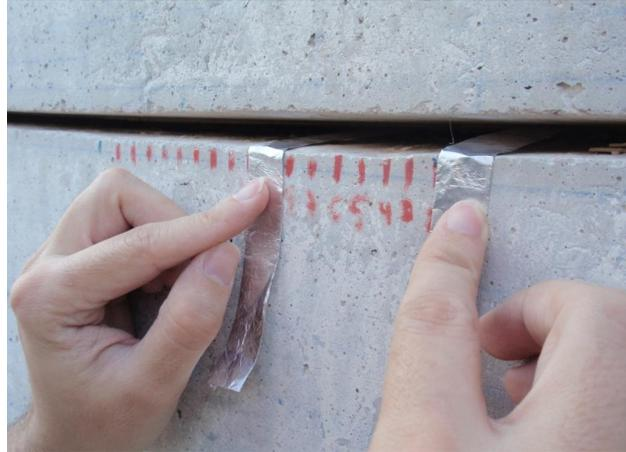
**Fig. 41. Colocación de reflectores metálicos en el corte del bloque de hormigón**
