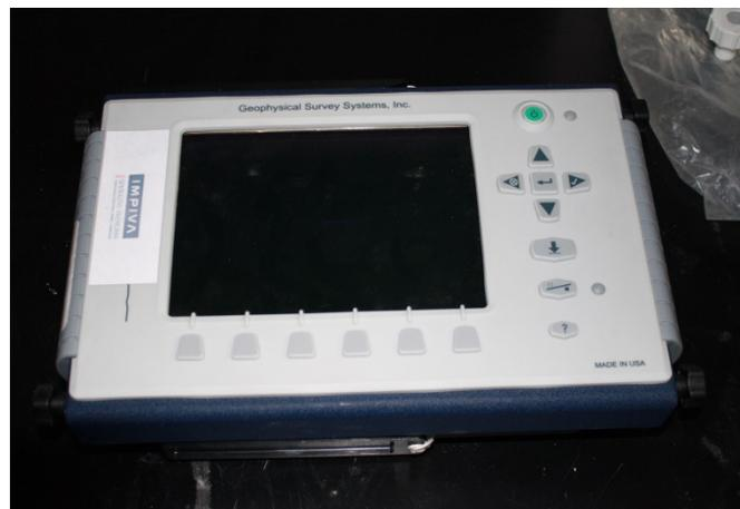
Fig. 30. Unidad central de control SIR 3000 con pantalla de visualización integrada de la marca GSSI
