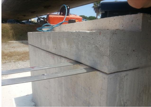
**Fig. 47. Detalle colocación de las láminas de acero**
