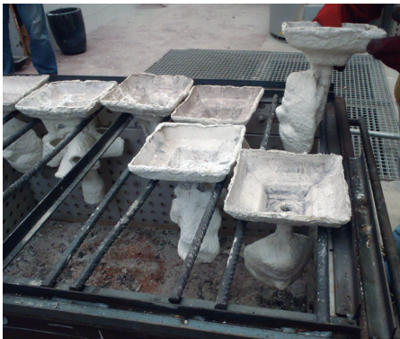
Fig. 68. Preparación de las piezas para colada.
