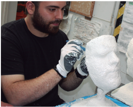
Fig. 66. Aplicación de fibra de vidrio a la pieza.
