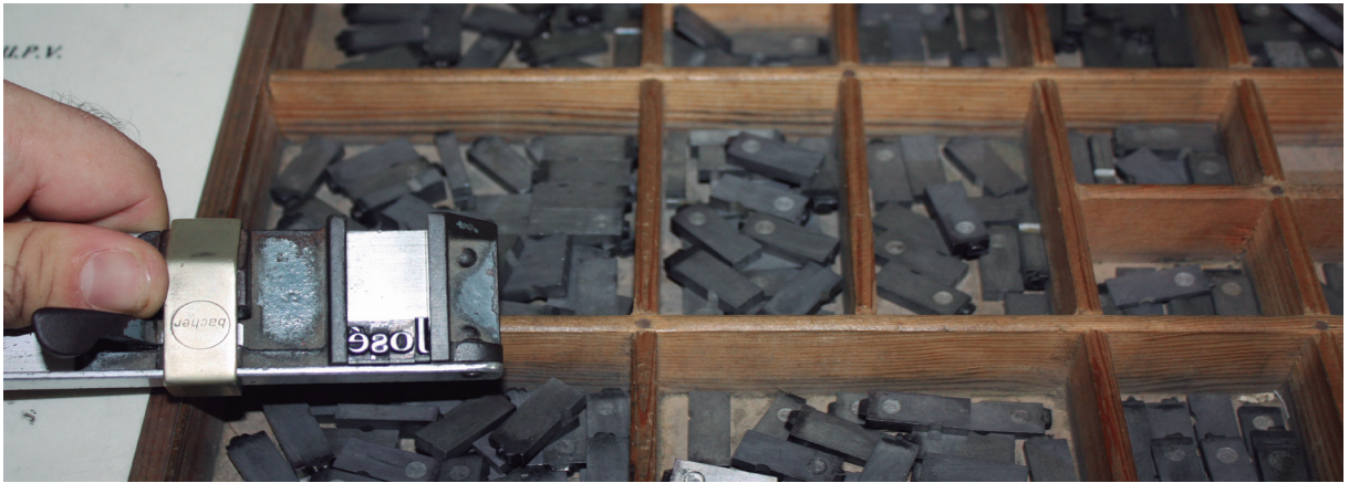
Fig. 52. Proceso de composición con tipos móviles de imprenta para el gofrado del título y nombre.
