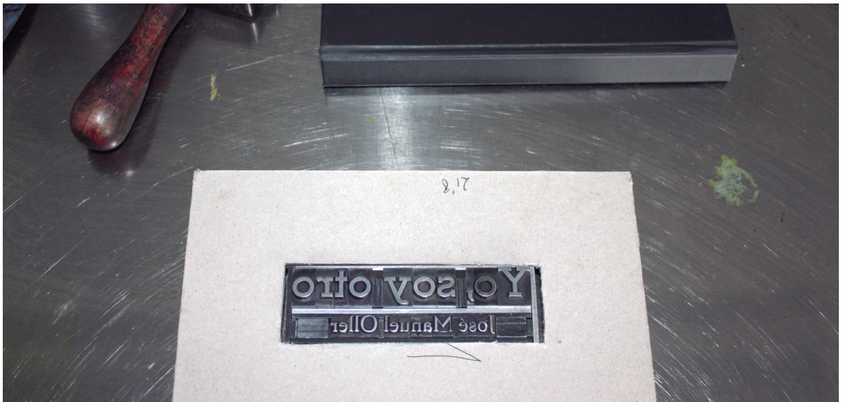
Fig. 53. Composición de tipos móviles preparada para estampación en prensa vertical.
