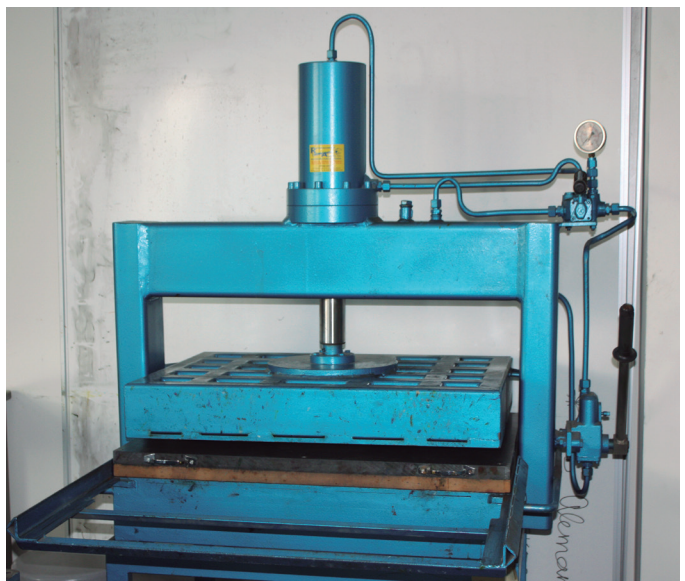
Fig. 55. Proceso de realización del gofrado con prensa.
