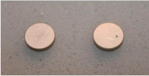
Figura III.5 Cerámicas piezoeléctricas usadas en los sensores
