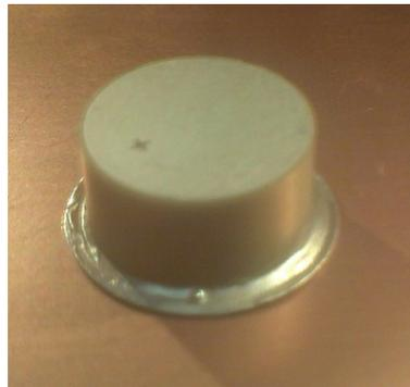
Figura II.8. Unión entre cerámica y lámina de protección
