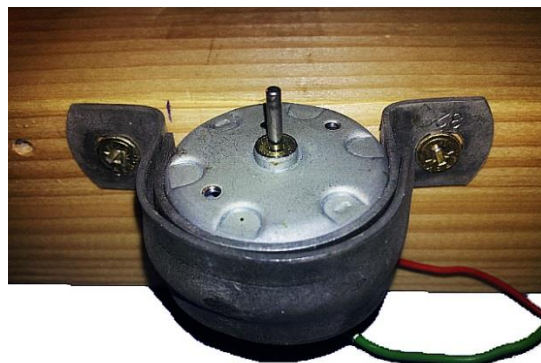
Figura 4.15. Montaje Motor DC
