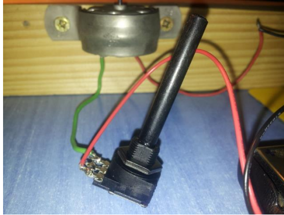
Figura 6.7. Regulación velocidad motor
