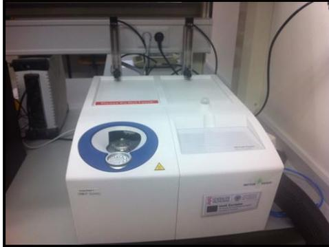
**Figura III.11. Equipo de medición de calorimetría DSC**
