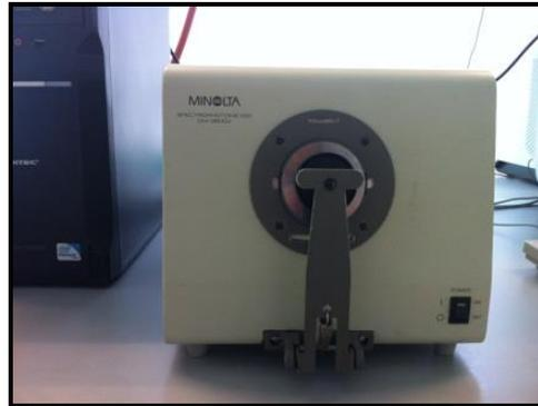
**Figura III.7. Equipo para medir transparencia (Espectro colorímetro Minolta)**
