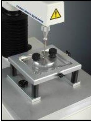
**Figura III.6. Equipo para medir propiedades mecánicas (Prensa Universal)**
