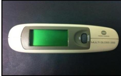
**Figura III.8. Equipo para medir brillo (Multi-Gloss MINOLTA)**
