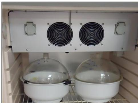
**Figura III.3. Desecadores en cámara a temperatura y humedad controlada**
