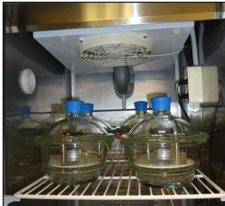
**Figura III.4. Copas en desecador y en estufa a temperatura y humedad controlada.**
