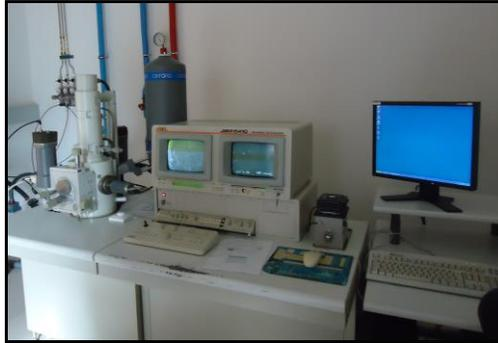
**Figura III.9. Equipo para observar microestructuras JEOL®**
