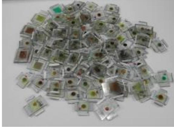
**Figura 47.** Imagen de diferentes células de Grätzel fabricadas en el laboratorio del ICIQ utilizando diferentes colorantes.
