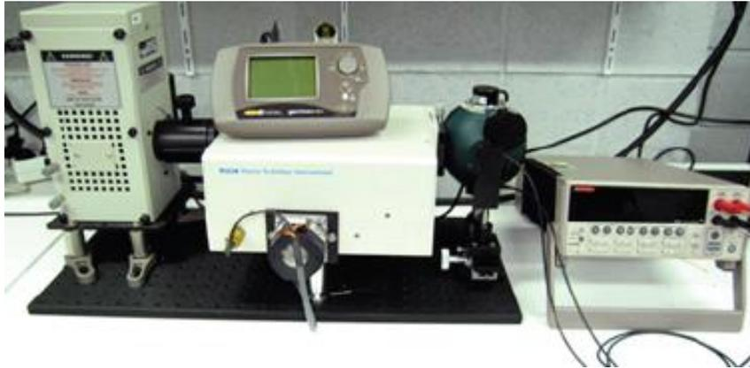
**Figura 28.** Equipo usado en el laboratorio del ICIQ para medidas de IPCE.
