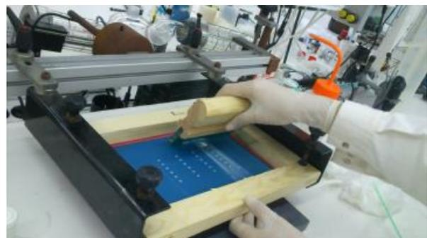
**Figura 39.** Preparación de la pasta de  $\text{TiO}_2$  en el laboratorio del ICIQ.
