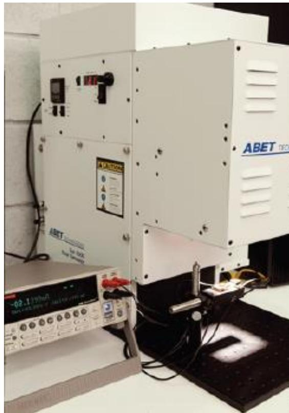
Figura 13. Simulador solar utilizado en los laboratorios del ICIQ.
