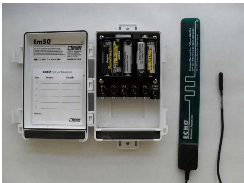
Figura 3.3. Datalogger EM50 (izquierda), sonda de humedad EC-20 (centro) y sonda de temperatura (derecha).
