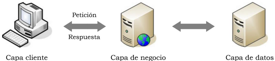
Figura 19 - Estructura de una aplicación Web a 3 niveles.
