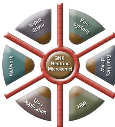
Figura 26. Esquema de comunicación el microkernel QNX Neutrino RTOS con el resto de componentes de SO.
