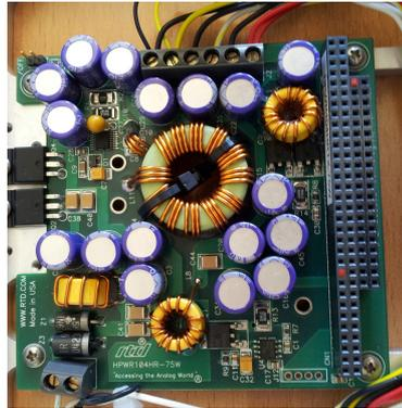
Figura 25. Fuente de alimentación HPWR104HR-75W.
