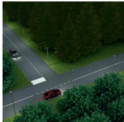
Se colocan dos tipos de iluminación para marcar el camino: báculos y cajas de LED's.
