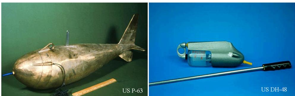
Figure 4.4 – Sampling instruments P63 and DH48.
