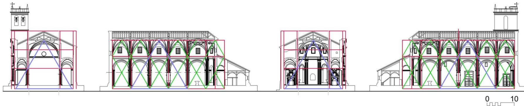
Fig VII.45: Volcado de la red de triángulos equiláteros y ejes obtenidos del crecimiento del edificio sobre secciones.
