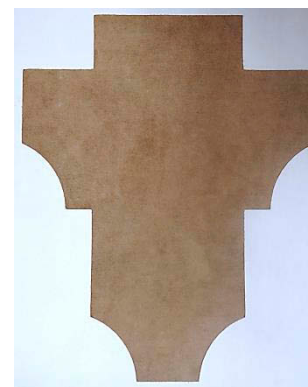
Fig VII.197: Plantilla de los nervios de las crucerías del templo de Vistabella obtenido sobre madera.
