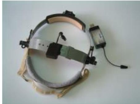
Figura 3: Casco con sensor inercial
