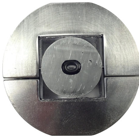
Figura 3.35: Ubicación de la junta superior en la tobera.
