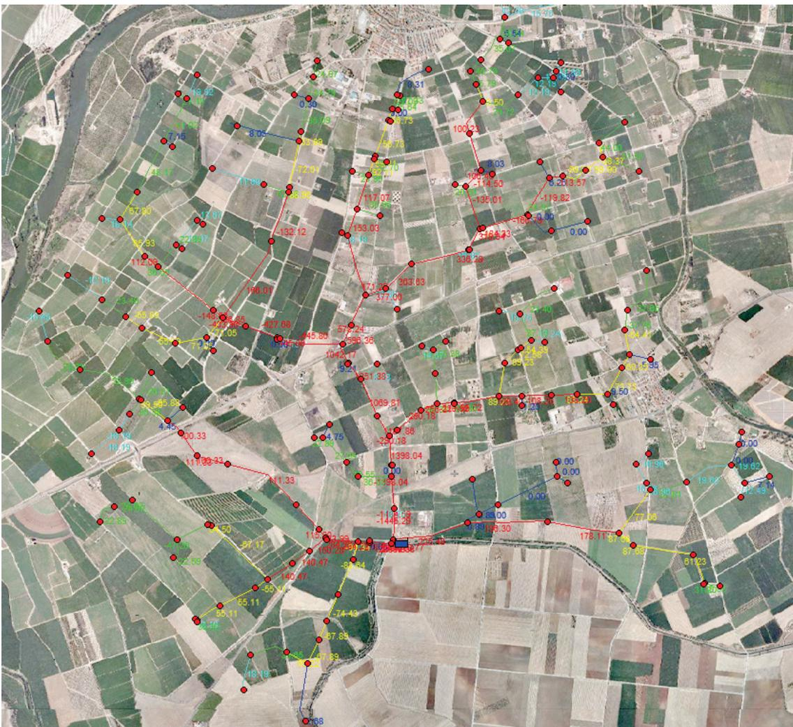
**FIGURA 34: RED REPRESENTADA MEDIANTE EPANET SOBRE EL SECTOR HIDRÁULICO**
