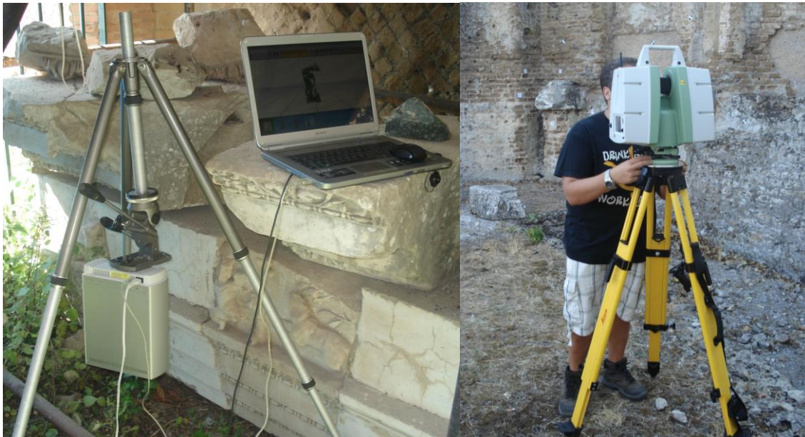
Figuras 6.10 y 6.11. Imágenes de los dos tipos de escáner láser usados en el levantamiento.
