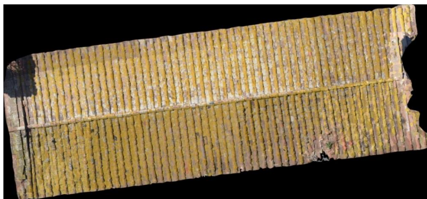
Figura 3.20. Malla de la cubierta con la incorporación de la textura foto-realista realizada en el software PhotoModeler Scanner .
