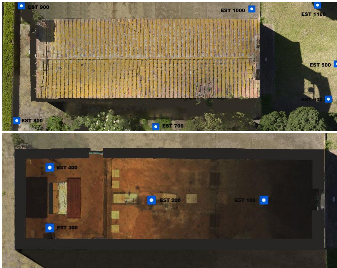
Figuras 8.10 y 8.11. Arriba, imagen de las estaciones del escáner en el exterior de la iglesia. Abajo, imagen de las estaciones del escáner en el interior. La estación 500 se utiliza como estación de referencia para realizar la alineación con las escaneados del interior; desde la posición 500 se escanea el target situado en el punto 100, y viceversa.
