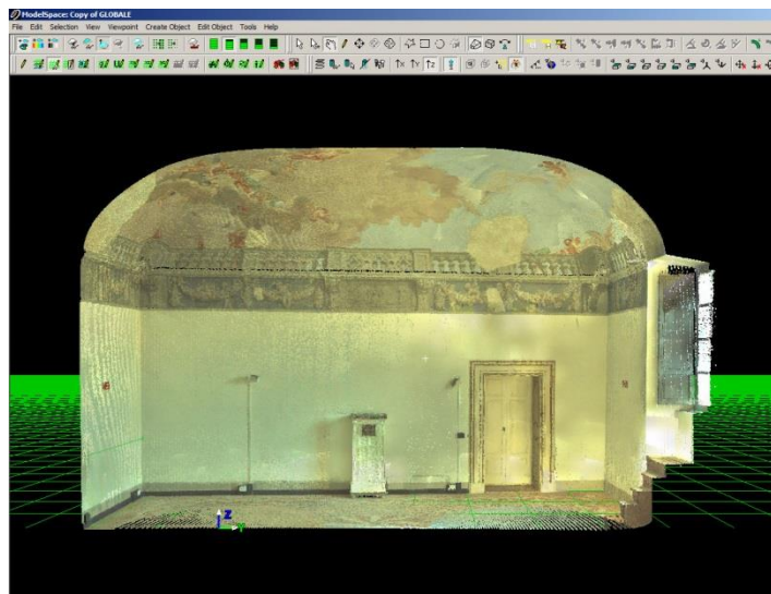
Figura 7.11. Sección vertical de la nube de puntos de la estancia.
