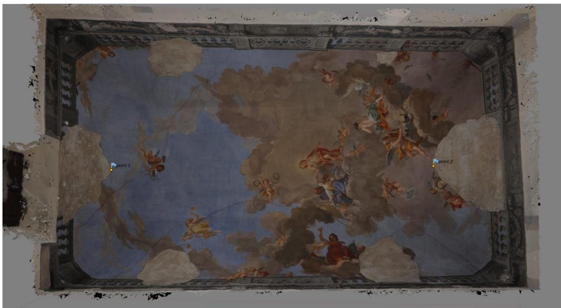
Figura 7.64. Imagen del modelo realizado con PhotoScan , con textura foto-realista de alta calidad.
