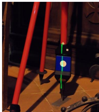
Figura 3.32. Imagen de un target en el momento del rastreo de su posición.
