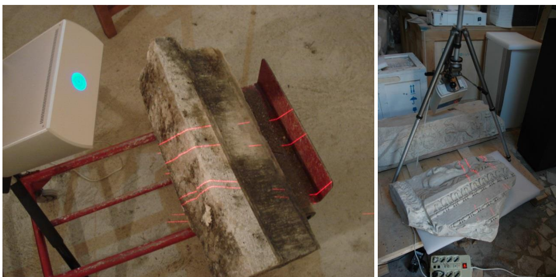
Figuras 3.22 y 3.23. Imágenes de un escáner láser a triangulación en las que se puede observar el proceso de adquisición de datos.
