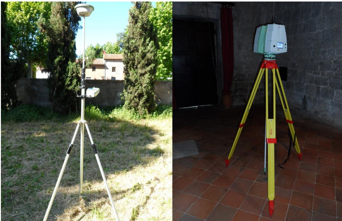
Figuras 8.08 y 8.09. Imagen del GPS sobre un punto de estacionamiento en el exterior de la iglesia, a la izquierda, y a la derecha, imagen del escáner láser sobre un punto de estacionamiento en el interior.
