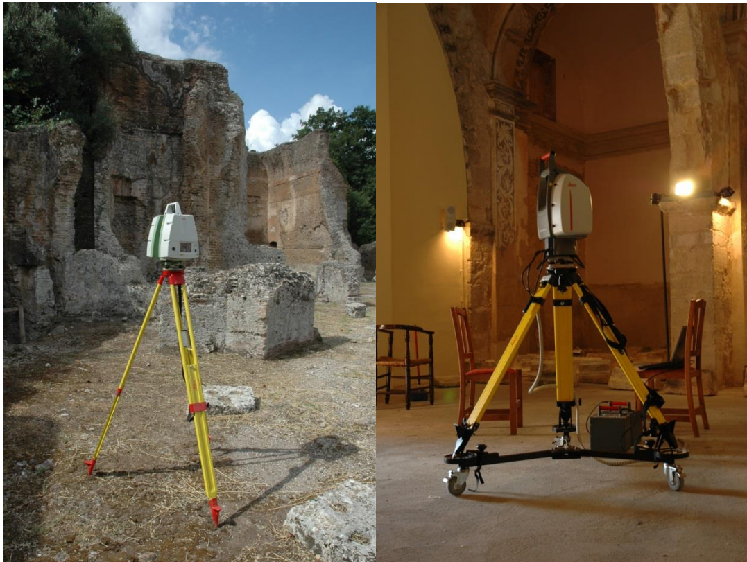
Figuras 3.24 y 3.25. Escáneres a Tiempo de Vuelo, a la izquierda Scanner Láser Leica C10, a la derecha Scanner Láser Leica HDScanStation 2.
