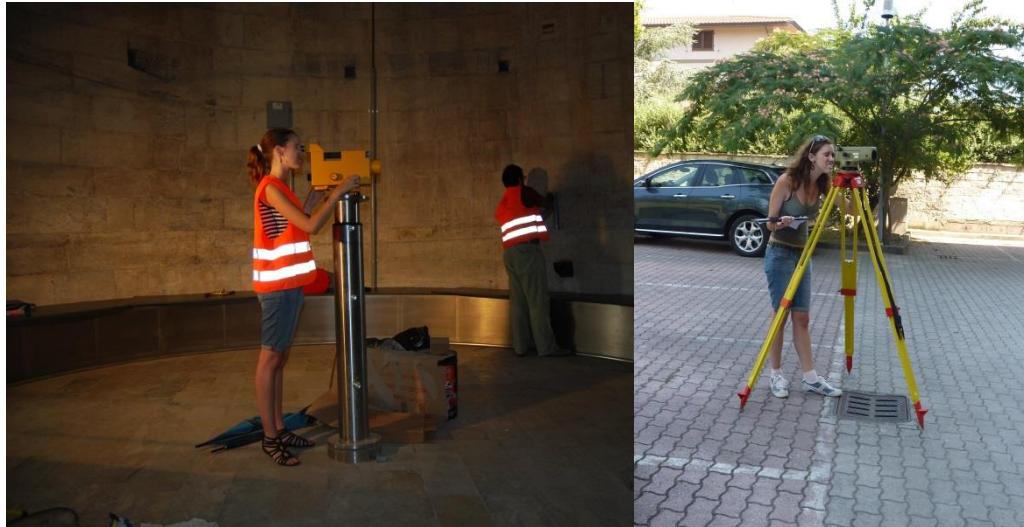
Figura 3.01 y 3.02. Imágenes de dos instrumentos de medición altimétrica. A la izquierda un nivel topográfico fijo situado dentro de la torre de Pisa. A la derecha un nivel topográfico situado sobre un trípode.
