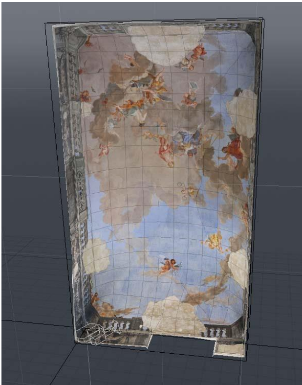
Figuras 3.37 y 3.38. A la derecha, imagen de la bóveda realizada con escáner láser, a la cual se le ha introducido una textura foto-realista mediante fotografías. A la izquierda la UVmap de dicha bóveda a través de la cual ha sido posible aplicar dicha textura mediante imágenes individuales.
