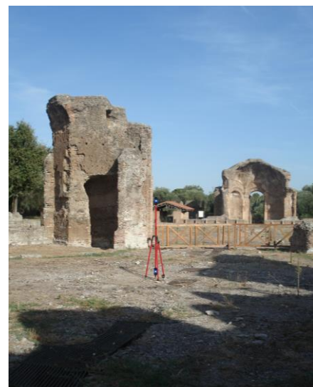
Figura 6.18. Imagen de un de los target usados para la alineación de las capturas.
