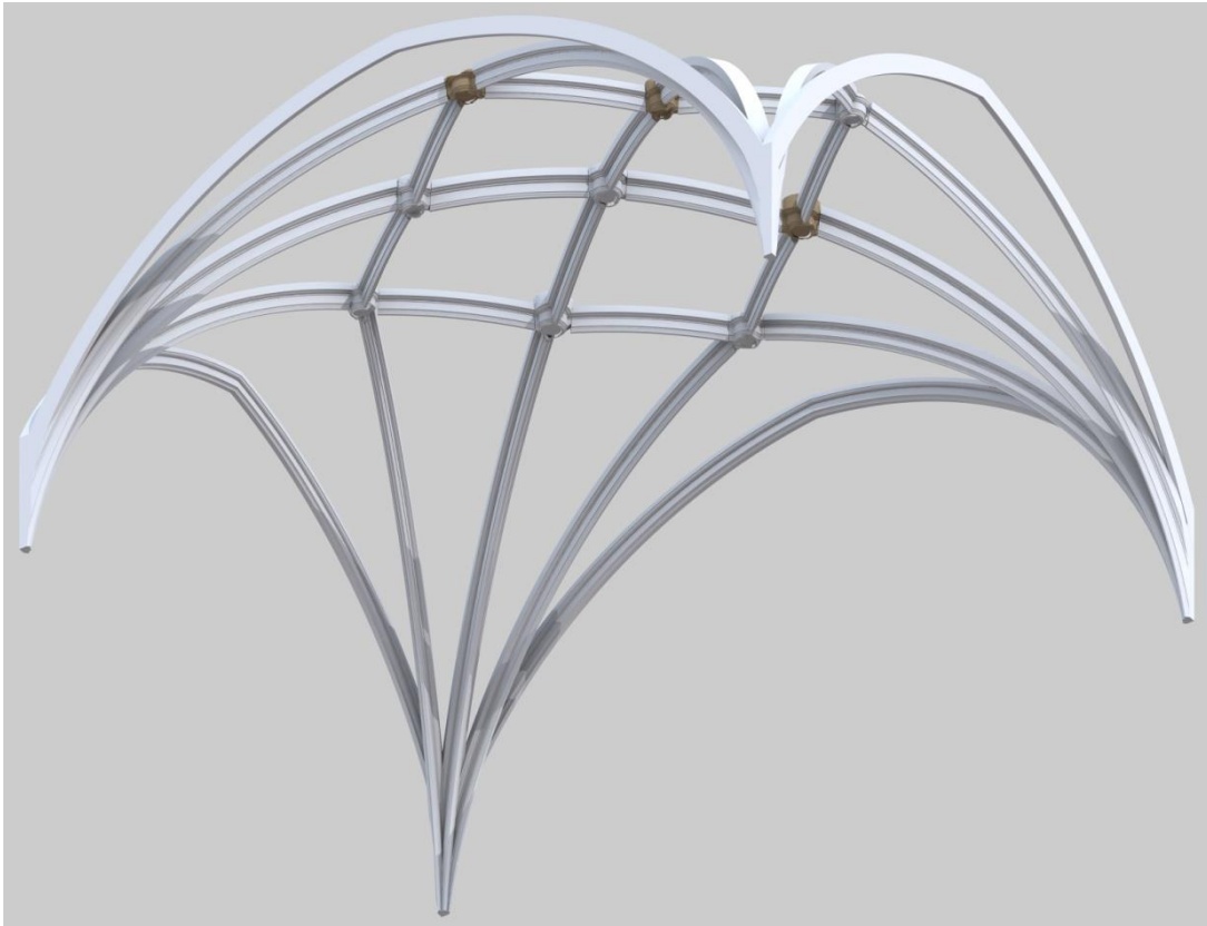
Figuras 5.83 y 5.84. En la imagen superior, axonometría de la bóveda vista desde abajo. En la inferior, axonometría vista desde arriba. En ambas se presentan las claves que no se tienen en diferente color al resto de la bóveda.
