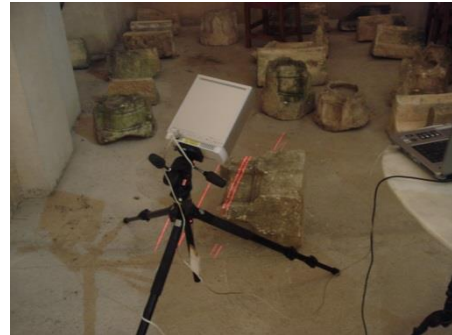
Figuras 5.12 y 5.13. Escáner realizando el barrido de una clave arriba y de una dovela abajo
