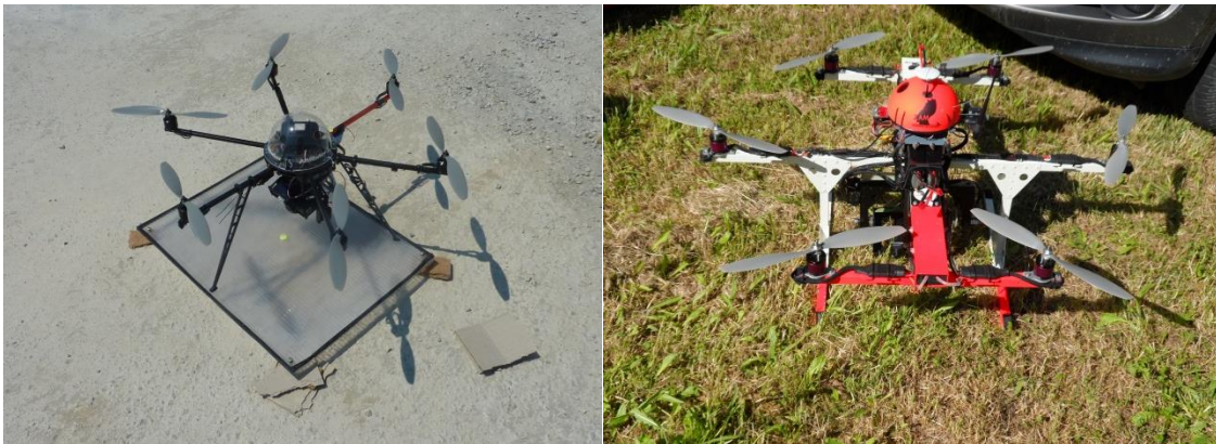
Figuras 3.05 y 3.06. Imágenes de dos UAV, utilizados para hacer un levantamiento de la cubierta de una iglesia y el puerto marítimo de Marina di Pisa.
