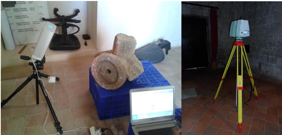
Figura 3.03. Escáner láser a triangulación NextEngine Model 2020i. Figura 3.04. Escáner láser a Tiempo de Vuelo Leica C10.
