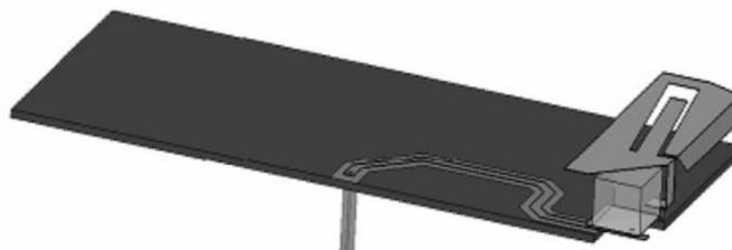
Figura 55. Antena alimentada mediante una carga capacitiva de tipo dieléctrico.
