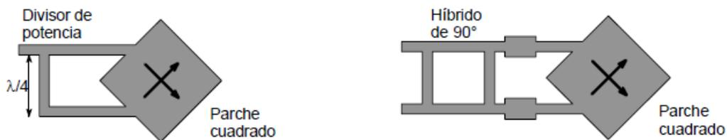
Figura 17. Desfase mediante diferentes longitudes de onda o mediante el uso de un circuito híbrido.
