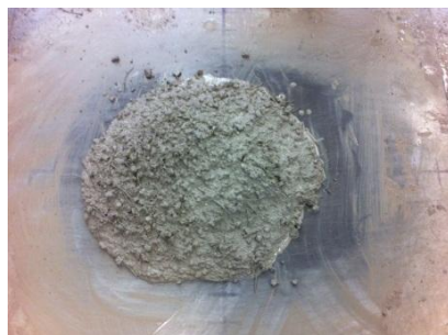
Imagen 4. 54 Ensayo escurrimiento fibras y hormigonado molde
