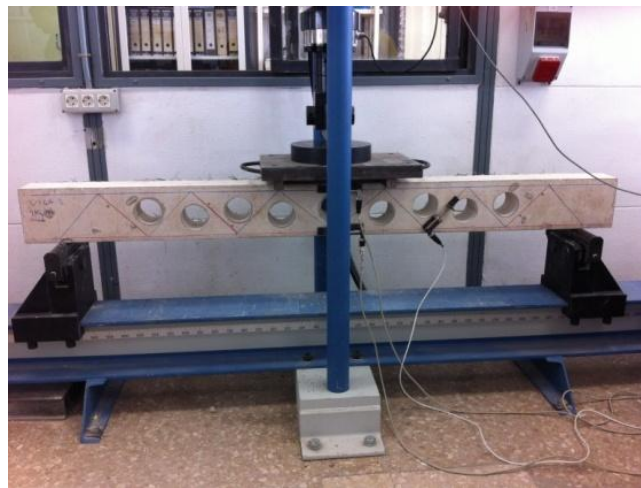
Imagen 3. 16 Ensayo a flexión viga aligerada
