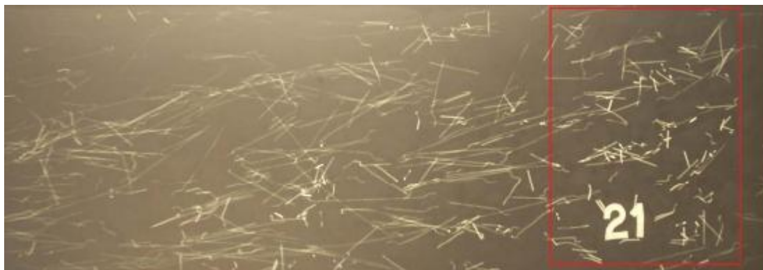
Imagen 2. 16 Distribución de fibras en un hormigón convencional
