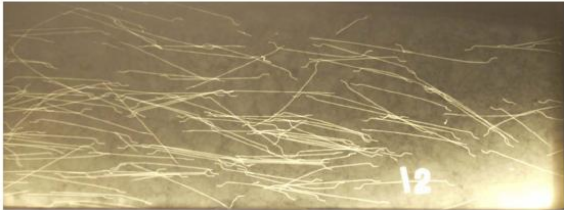
Imagen 2. 17 Distribución de fibras en un hormigón autocompactante
