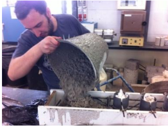
Imagen 4.46 Vertido de hormigón
