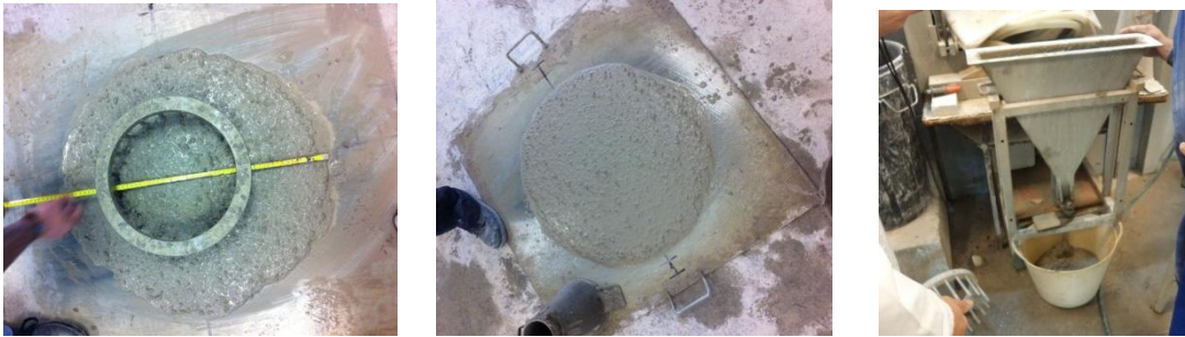
Imagen 4. 52 (Izda. a Dcha. Ensayo anillo Japonés, escurrimiento, embudo V)
