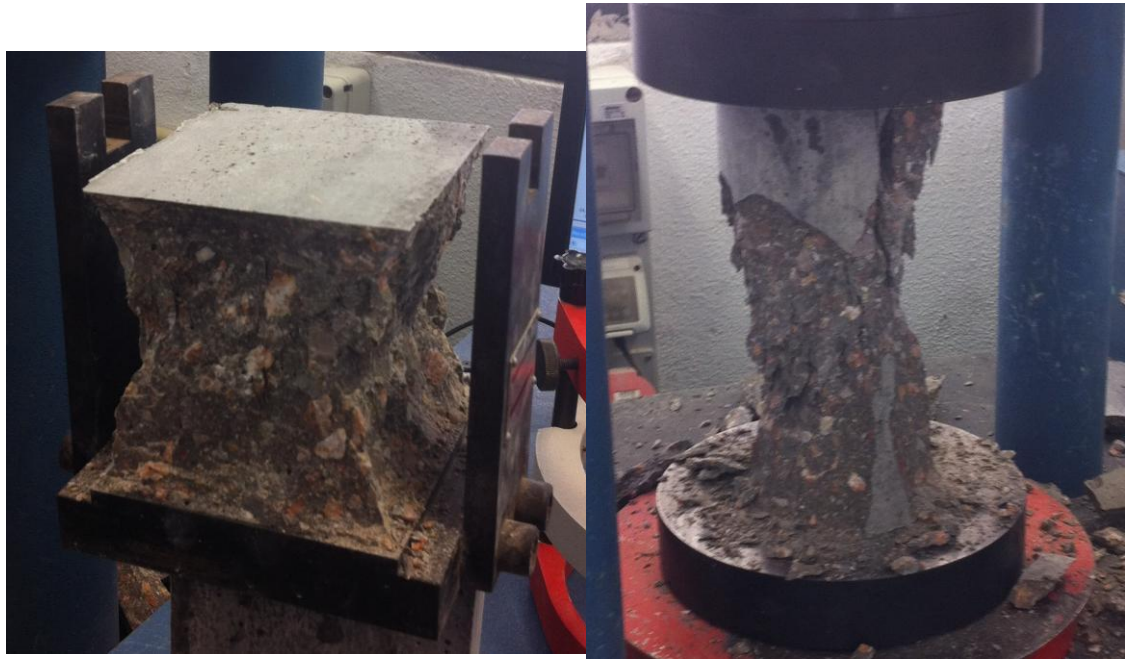
Imagen 2. 10 Roturas de probetas a compresión
