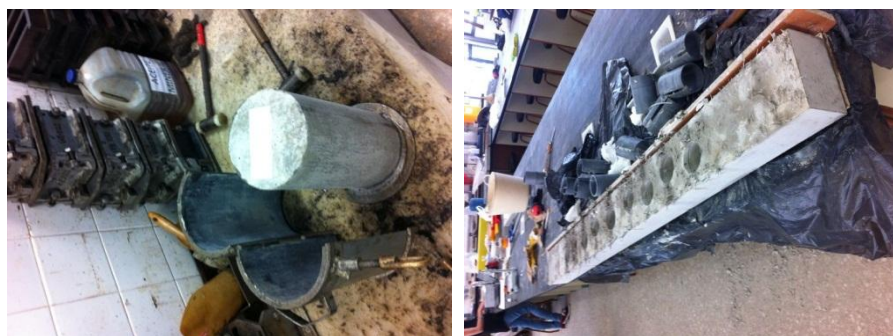
Imagen 4. 56 Desmoldado de probetas y desencofrado de viga
