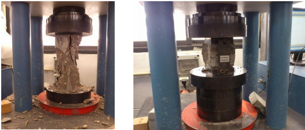
Imagen 4. 70 Ensayo Compresión probeta cilíndrica y prismática
