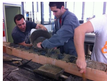
Imagen 4. 54 Ensayo escurrimiento fibras y hormigonado molde
