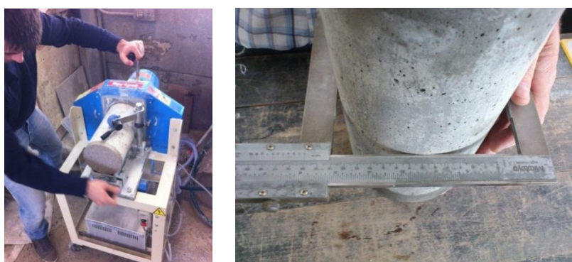
Imagen 4. 69 Refrentado de probeta y medición de diámetro
