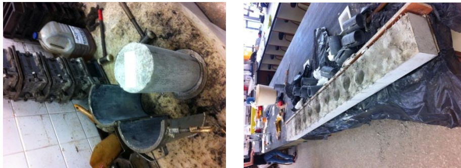
Imagen 3. 11 Probeta Desmoldada (izquierda) Viga desencofrada (derecha)
