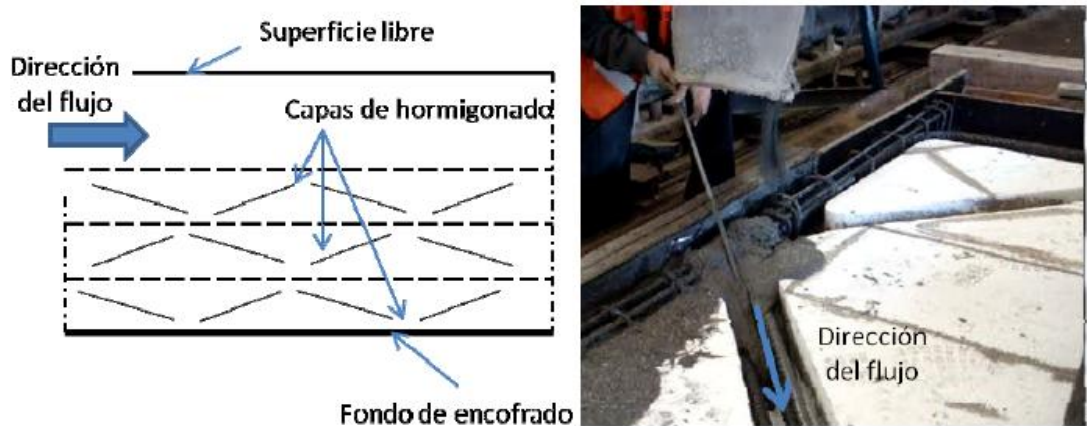
Imagen 2. 6 Vertido en una planta de prefabricado
