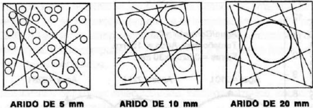
Ilustración 2. 1 Efecto del tamaño del árido en la distribución de las fibras dentro de un cuadrado de lado igual a la longitud de éstas (F. Cánovas, ACHE, 2000)
