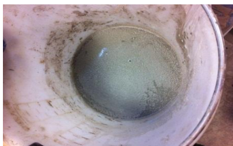
Imagen 4. 51 Disolución promotor adherente sólido y vertido de agua con superplastificante
