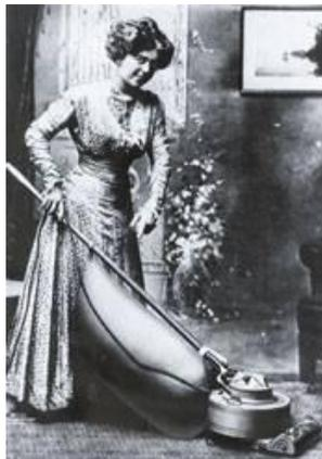
Figura 2.5. Imagem primerio aspirador de pó portátil
