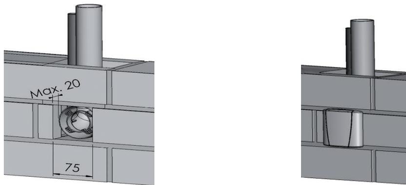
Imagem 3.13. Instalação numa parede de tijolo
