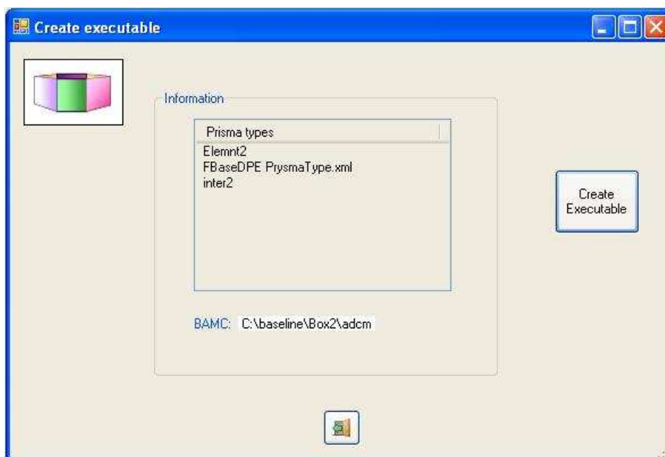
Figura 109 IGU para ingresar la especificación PRISMA a las herramientas PRISMA y crear el ejecutable del sistema final
