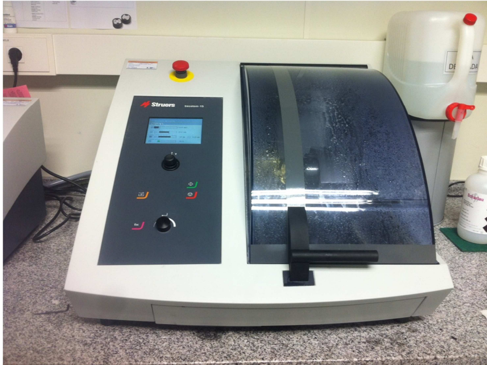
Figura 26. Cortadora de precisión Struers Secotom 15 en funcionamiento.
