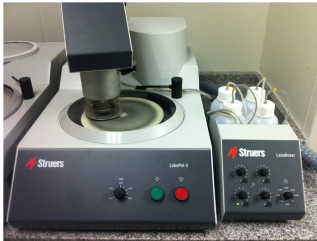
Figura 30. Equipos de desbaste en funcionamiento con las probetas colocadas
