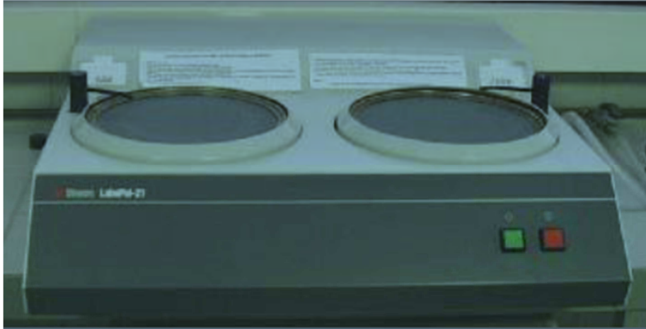
Figura 29. Equipo Struers Labopol 21 de platos giratorios para preparación por desbaste de las muestras.
