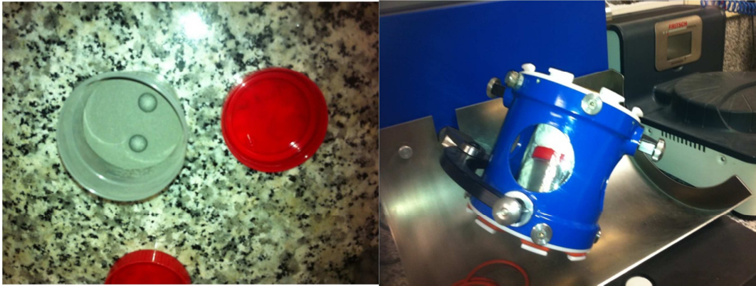
Figura 22. En primer lugar bote estanco con 2 bolas de alúmina y la aleación correspondiente. En segundo lugar túrbula con dos botes estancos dentro de un bote más grande que cabe en la túrbula.
