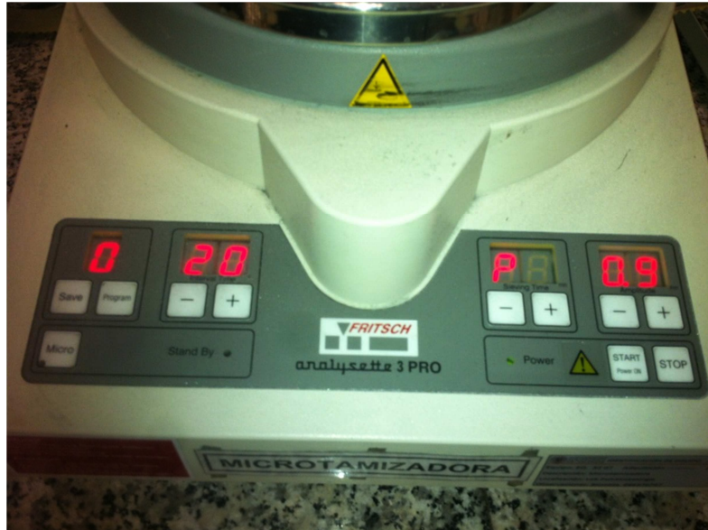
Figura 21. Microtamizadora con malla de luz de 25 micras
