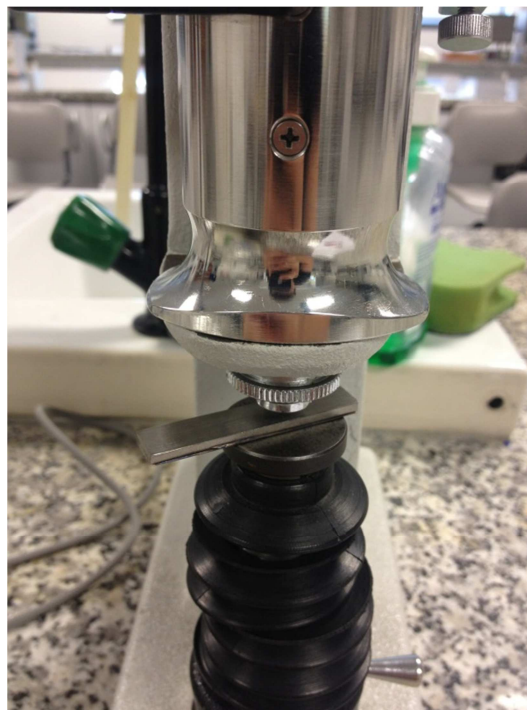
Figura 38. Módulo de ensayos que aplica una carga sobre la muestra y transfiere la penetración al módulo de control
