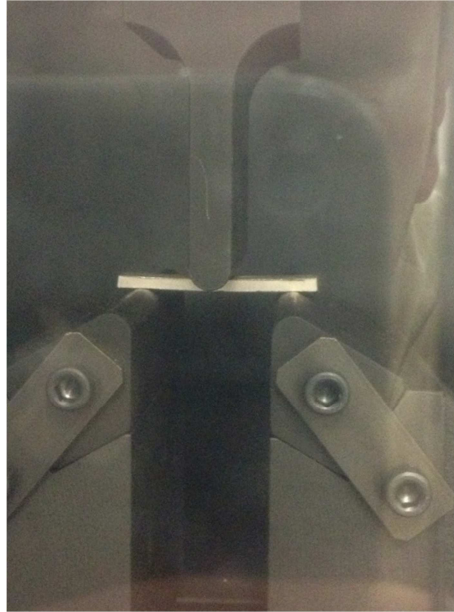
Figura 36. Probeta rectificada colocada sobre dos apoyos donde el punzón superior aplica la carga en el equipo de ensayo.
