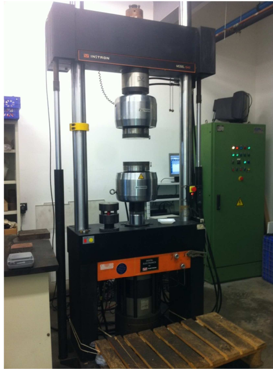
Figura 23. Prensa Instron modelo 1343
