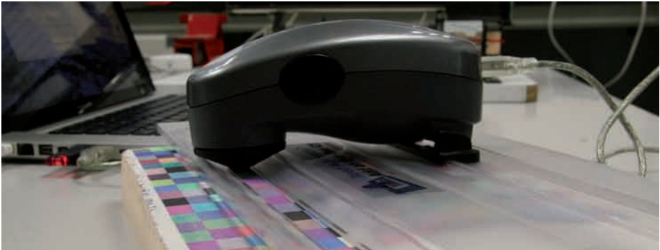
Fig.4.27 Proceso de medición de los parches impresos con el espectrofotómetro.
