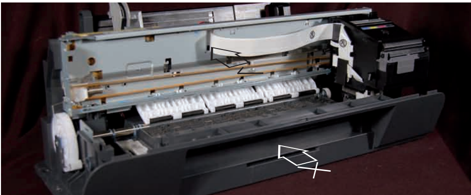
Fig.2.1 Estructura inferior a eliminar encargada de cargar y desplazar el papel.
