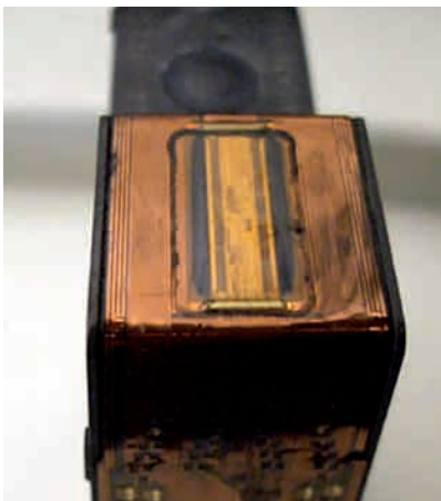
Fig.1.5 Cabezal térmico integrado en el cartucho.
