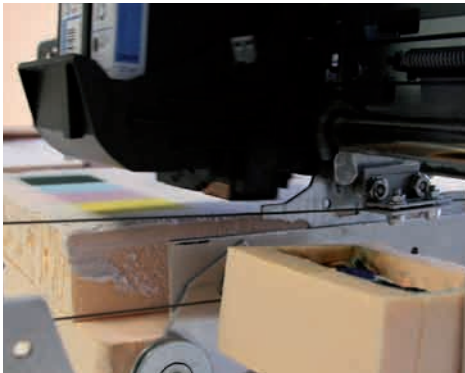
Fig.4.24 Cabezales a 8mm de distancia.
