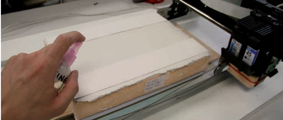
Fig.4.50 Aplicación del Bonding Agent instantes antes de imprimir, reservando los laterales.
