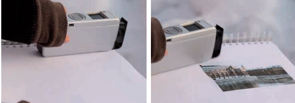
Fig.5.1 La impresora PrintBrush™ 4X6 de PrintDreams™ 4 genera la imagen deslizando la manualmente por la superficie.
