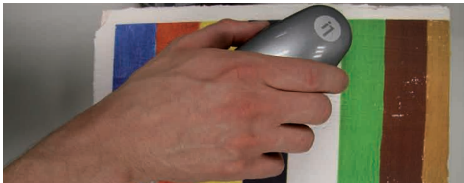
Fig.4.52 Medición del blanco de una de las superficies con el espectrofotómetro i1.
