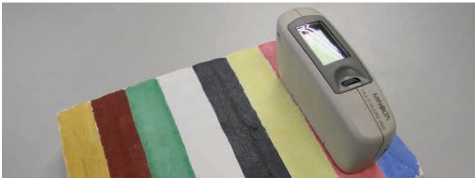
Fig.4.54 Brillómetro durante el proceso de medición de las superficies murales.
