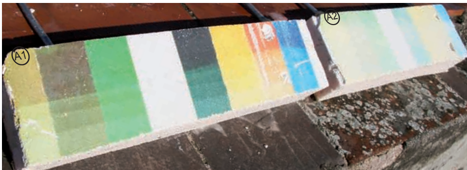
Fig.4.77 Probetas expuestas: A1 (mortero impreso al fresco), A2 (mortero impreso al seco).
