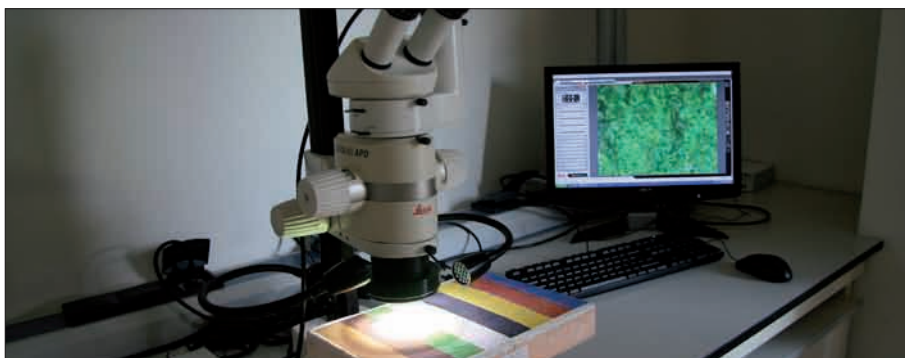
Fig.4.59 Microscopio Leica con cámara integrada para la digitalización de lo observado.
