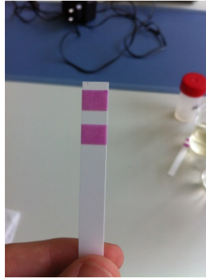
Fotografía 21. Tira soporte del reactivo para la medición de nitratos por reflectometría.
