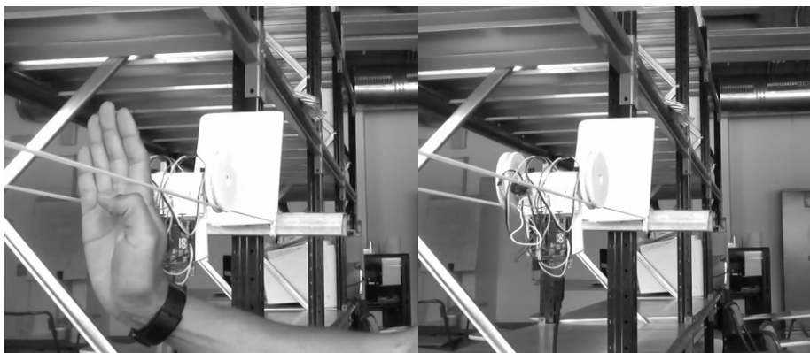
18.- Pruebas de dispositivo de movimiento con sensor de ultrasonidos MAX Sonar.
