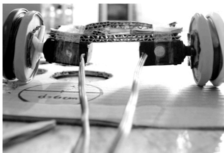
11.- Tren de desplazamiento de interfaz.
