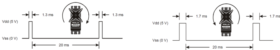
16.- Esquemas de funcionamiento de motores de rotación continua controlados mediante micro pulsos
