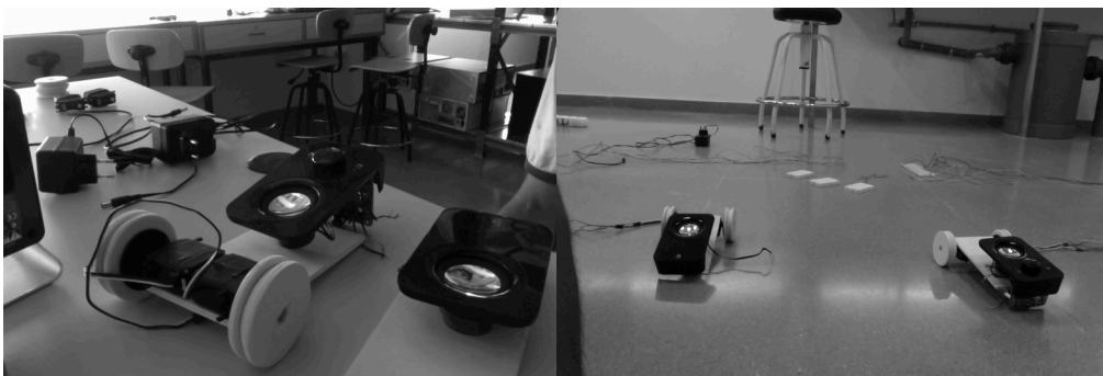
19.- Montaje de altavoces sobre las interfaces físicas de desplazamiento
