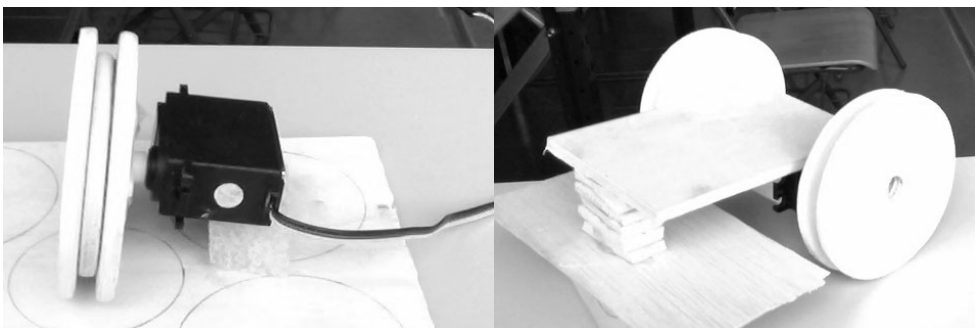
14.- Diseño de ruedas y plataforma de montaje de interfaz de movimiento
