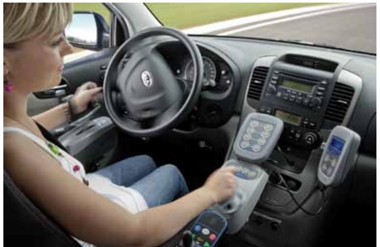
Figura 1. Interior de un vehículo con *joystick* (Por gentileza de Caradap).
