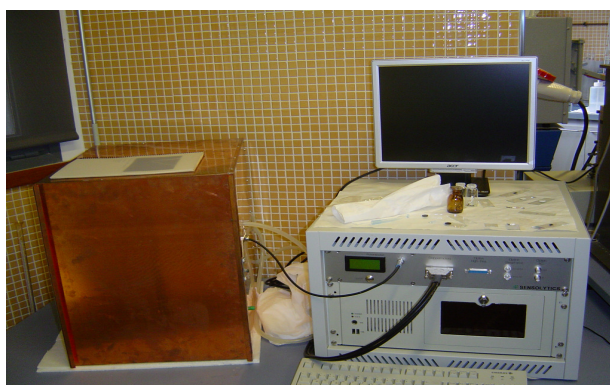
Figura. 2. Imagen del equipo SECM. A la izquierda se muestra la caja de Faraday y a la derecha el bipotenciostato.
