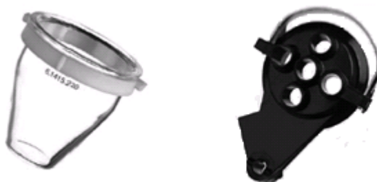
Figura 9. Célula electroquímica y dispositivo de cierre-sujeción utilizados en las experiencias voltamétricas con WE1D.
