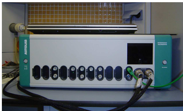
Figura 8. Potenciostato/galvanostato PGSTAT302 empleado para las medidas de voltametría cíclica.
