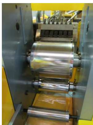
Figura 1. Obtención de películas en sistema de bobinas LBCR-150 acoplada a extrusora de doble tornillo LTE-20.
