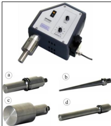
Figura 1. Ultrassom UP400S (Hielscher, Teltow, Alemanha) utilizado nos experimentos.
