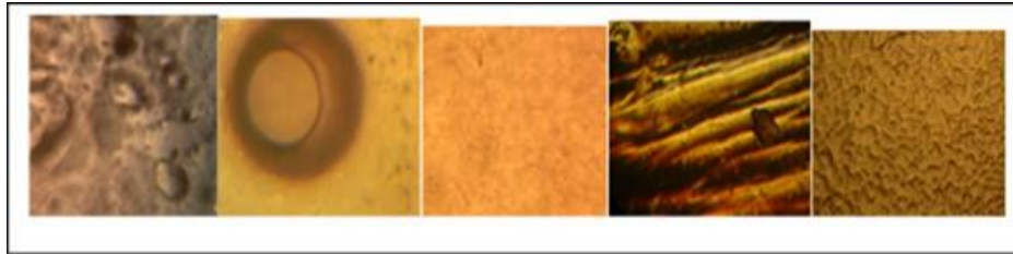
Figura 6. Microscopía de la estructura de películas elaboradas en diferentes concentraciones.
