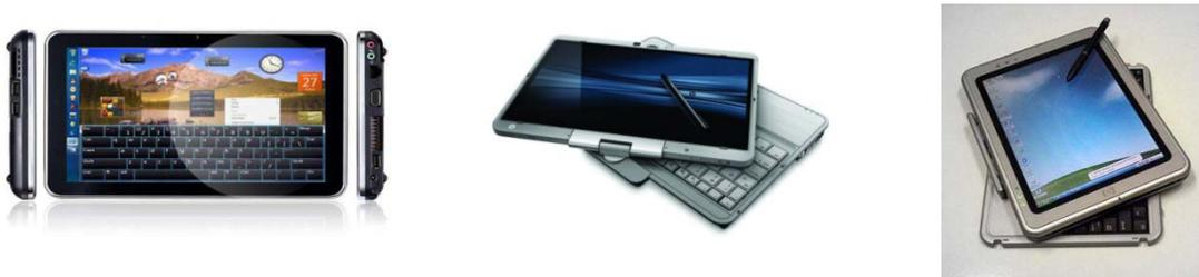
Figura 2-8: Tipos de TPC en función de su factor de forma.
