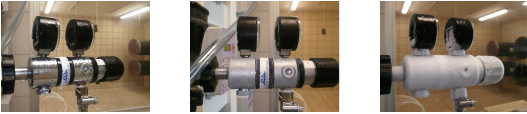
Figura 20: Proceso de congelación del manorreductor usado en las pruebas
