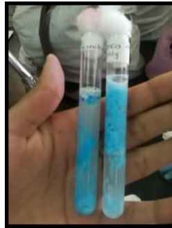
Figura 3. Observación del color de las muestra de leche con la solución de azul de metileno.
