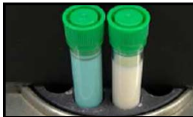
Figura 4. Tubo de leche con indicador azul de metileno a tiempo 0 (izquierda) y tubo de leche con indicador azul de metileno al cabo de 7 horas de incubación (derecha).
