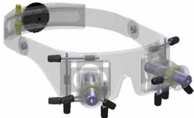
Figura 2. Modelo 3D del sistema de posicionamiento de los transductores de ultrasonidos diseñado por el IBV.
